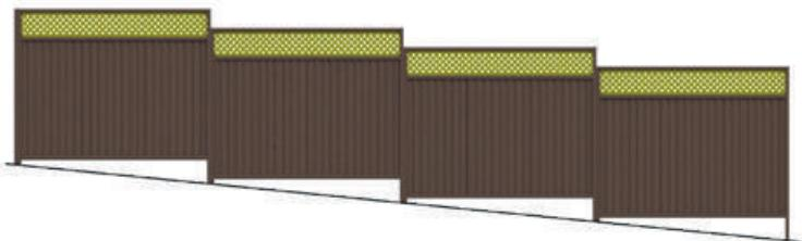
При большом перепаде грунта необходимо устанавливать ограждения ступенчато. Максимальное смещение соседних пролетов не должно превышать 250 мм.
